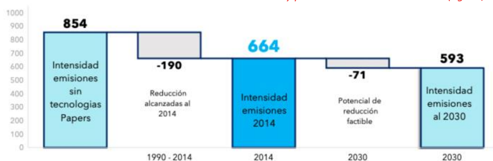
Ilustración 10. Reducciones al 2014 y potencial de reducción al 2030 (KgCO 2 /ton cemento)
